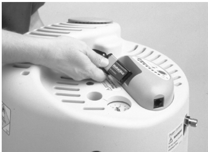
Figura 13. Sostituzione della batteria
