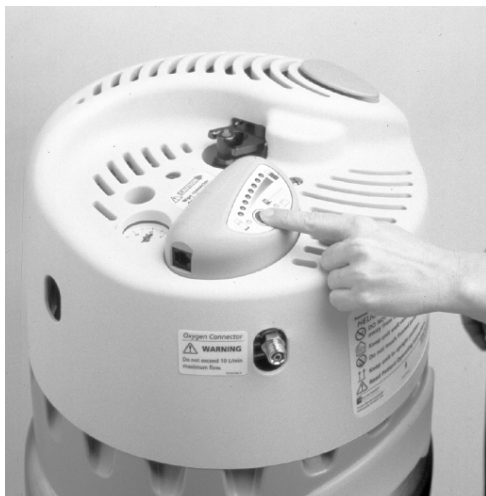
Figura 11. Controllo del contenuto di ossigeno nel serbatoio
