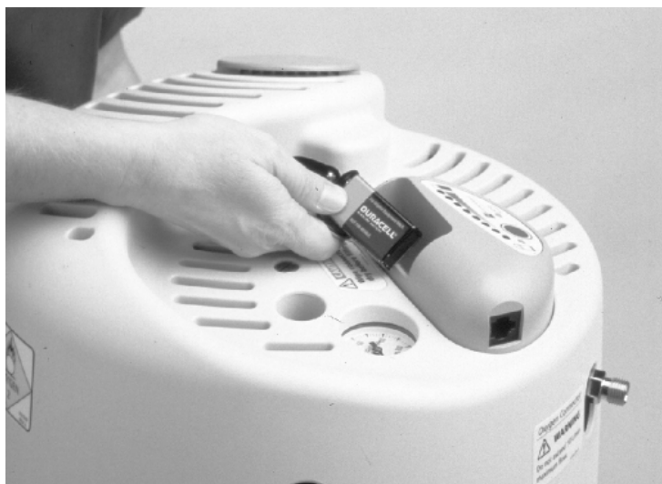
Figure 13: Remplacement de la batterie
